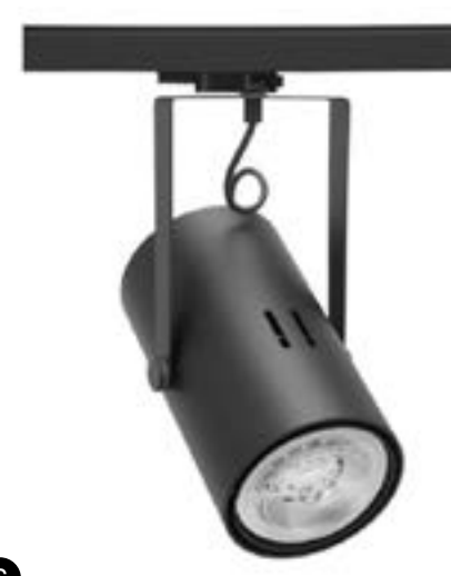
6 LIRA „GOLF“ schwarz/aluminium/stahl 12V /60 W /QR111/G53 H: 203 D: 157 mm EURO-STROMSCHIENENSYSTEM
